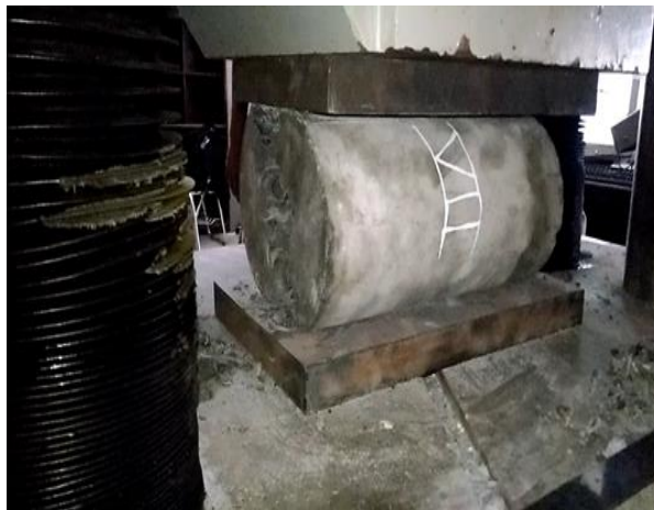
Gambar 3.21 Letak beton silinder dimesin pembebanan di laboratorium
