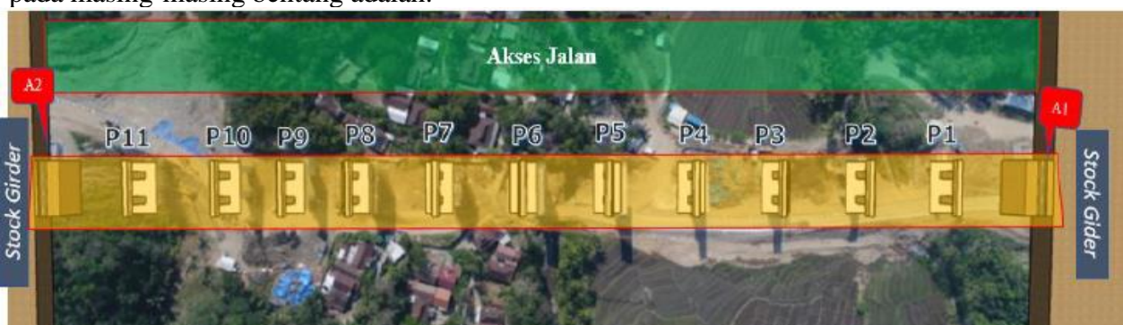
Gambar 5 Erection Plan Menggunakan Launcher Girder
