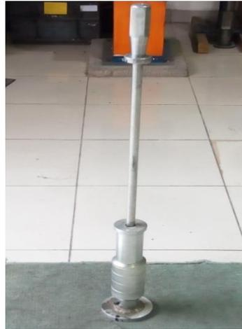
Gambar 3.3 Alat penumbuk atau pemadat benda uji
