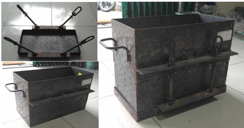
Gambar 3.2 Box cetakan benda uji
