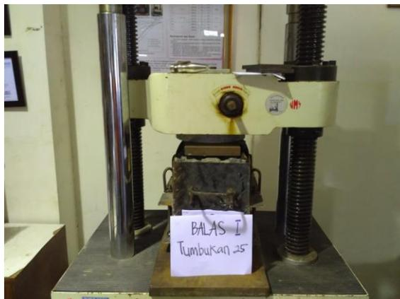
Gambar 3.9 Penempatan benda uji pada alat uji kuat tekan
