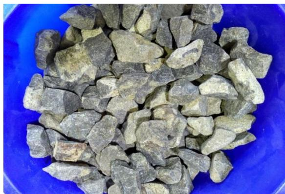
Gambar 3.5 Agregat kasar untuk material balas
