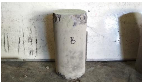
Gambar 83. Tampak sisi B setelah uji tekan
