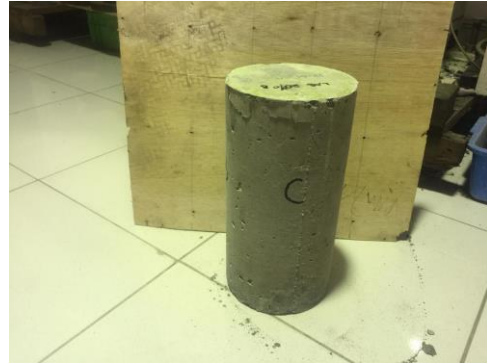
Gambar 79. Tampak sisi C beton setelah uji tekan
