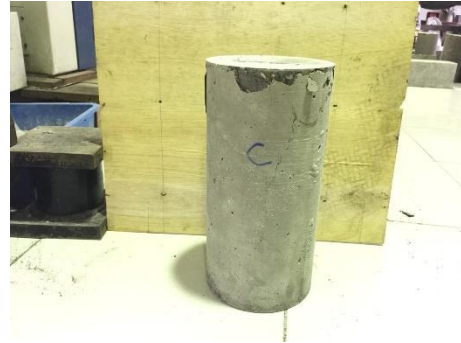
Gambar 34. Tampak sisi C beton setelah uji tekan
