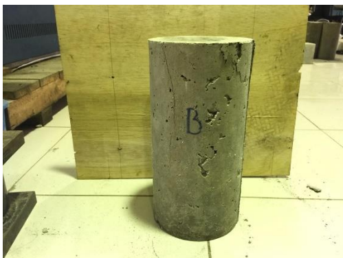
Gambar 18. Tampak sisi B beton setelah uji tekan
