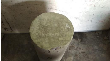
Gambar 51. Tampak sisi atas beton setelah uji tekan
