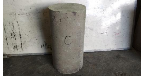
Gambar 109. Tampak sisi C setelah uji tekan
