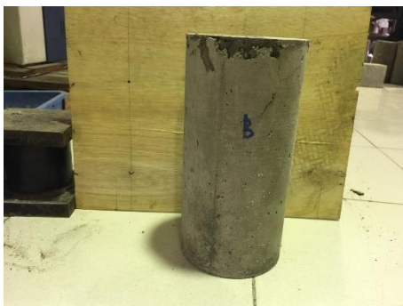
Gambar 33. Tampak sisi B beton setelah uji tekan
