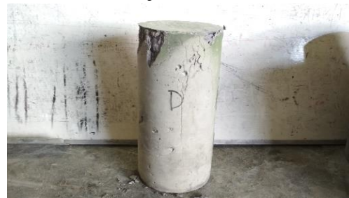
Gambar 90. Tampak sisi D setelah uji tekan
