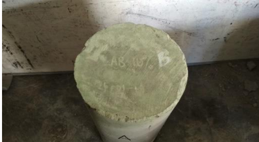
Gambar 96. Tampak atas setelah uji tekan
