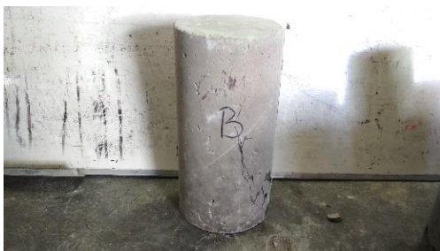
Gambar 93. Tampak sisi B setelah uji tekan
