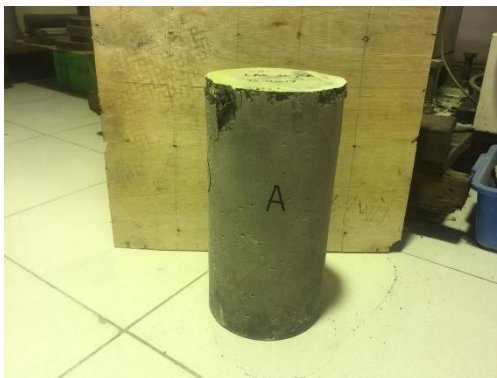
Gambar 67. Tampak sisi A beton setelah uji tekan
