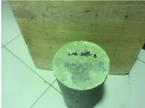
Gambar 76. Tampak sisi atas beton setelah uji tekan
