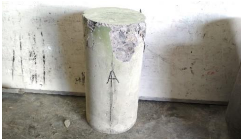
Gambar 87. Tampak sisi A setelah uji tekan
