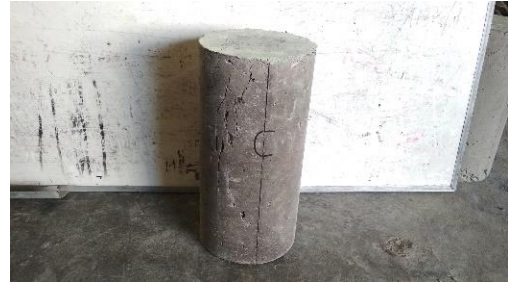
Gambar 104. Tampak sisi C setelah uji tekan
