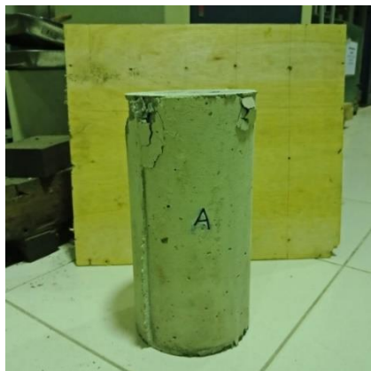
Gambar 42. Tampak sisi A beton setelah uji tekan
