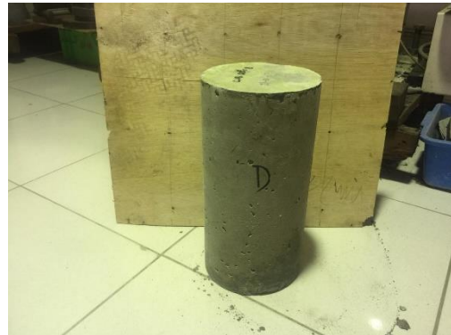
Gambar 80. Tampak sisi D beton setelah uji tekan
