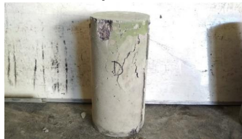
Gambar 85. Tampak sisi D setelah uji tekan
