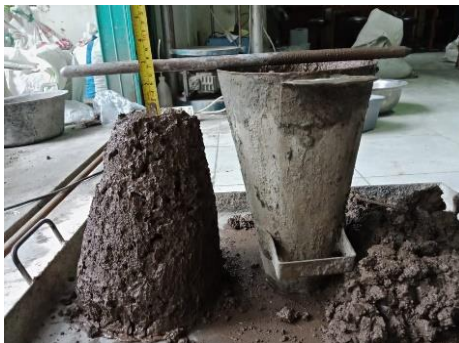
Gambar 126 Tinggi slump 6,5 cm
