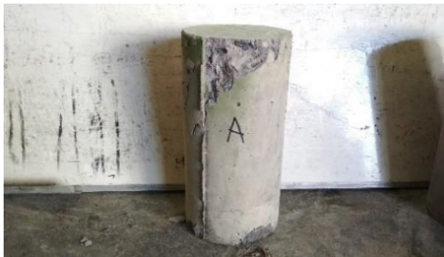
Gambar 82. Tampak sisi A setelah uji tekan
