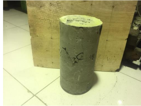
Gambar 74. Tampak sisi C beton setelah uji tekan
