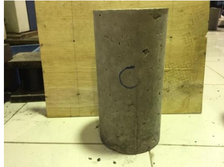
Gambar 14. Tampak sisi C beton setelah uji tekan
