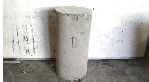
Gambar 120. Tampak sisi D setelah uji tekan
