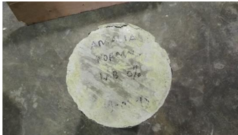
Gambar 1. Tampak sisi atas beton setelah uji tekan
