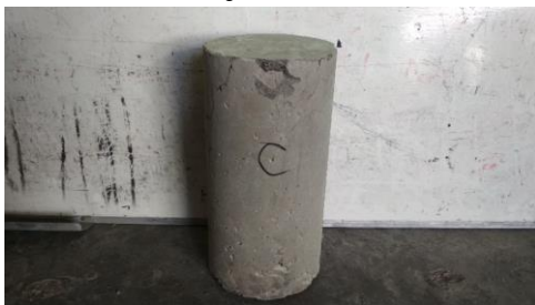
Gambar 114. Tampak sisi C setelah uji tekan
