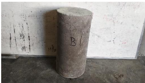
Gambar 103. Tampak sisi B setelah uji tekan
