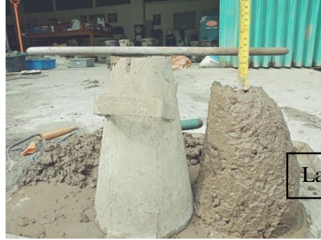
Gambar 124. Tinggi slump 6 cm
