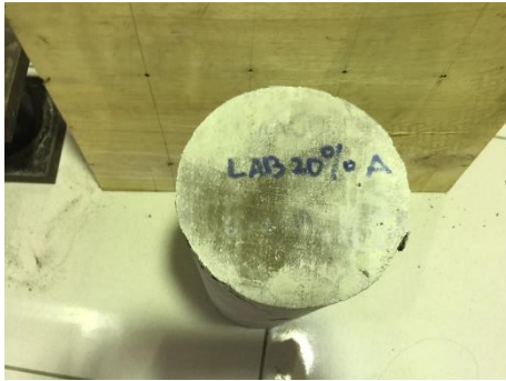
Gambar 11. Tampak sisi atas beton setelah uji tekan
