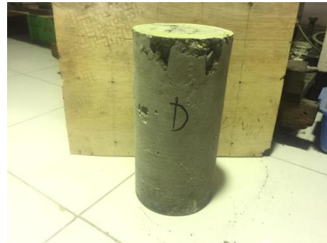
Gambar 75. Tampak sisi D beton setelah uji tekan
