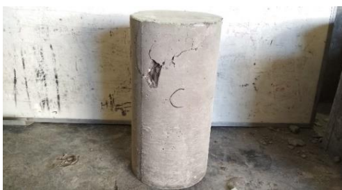
Gambar 59. Tampak sisi C setelah uji tekan
