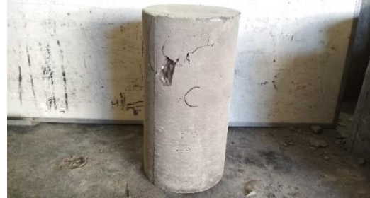
Gambar 99. Tampak sisi C setelah uji tekan
