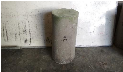
Gambar 107. Tampak sisi A setelah uji tekan
