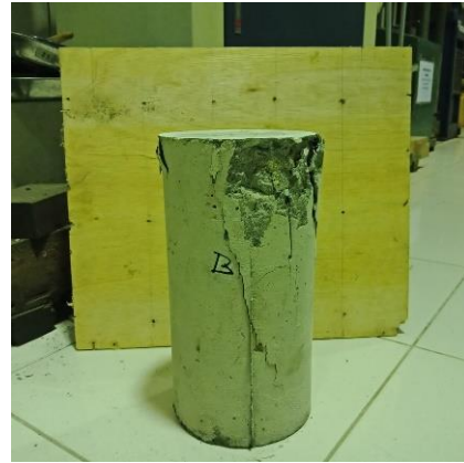
Gambar 48. Tampak sisi B beton setelah uji tekan
