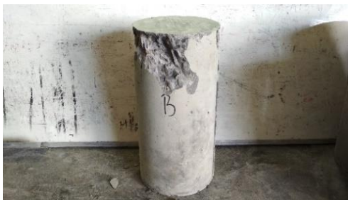
Gambar 88. Tampak sisi B setelah uji tekan
