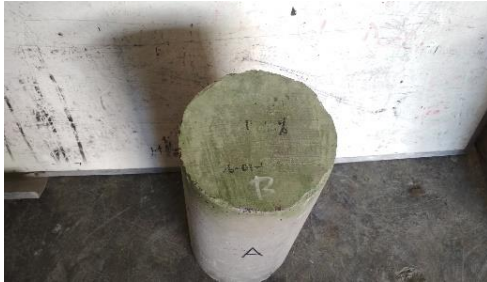
Gambar 106. Tampak atas setelah uji tekan
