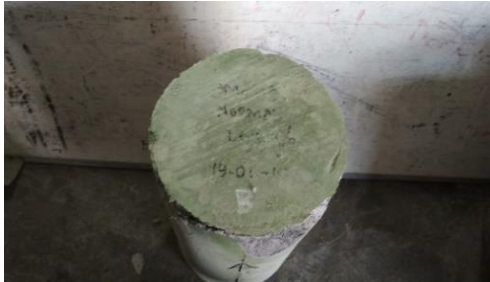
Gambar 86. Tampak atas setelah uji tekan
