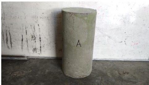
Gambar 112. Tampak sisi A setelah uji tekan
