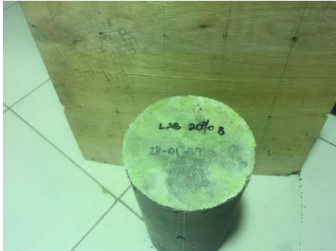
Gambar 66. Tampak sisi atas beton setelah uji tekan
