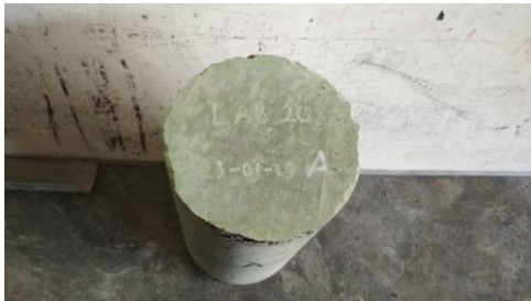
Gambar 111 Tampak atas setelah uji tekan
