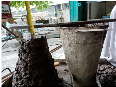
Gambar 128. Tinggi slump 4,5 cm
