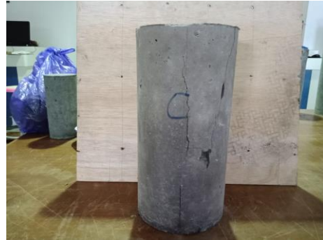
Gambar 9. Tampak sisi C beton setelah uji tekan
