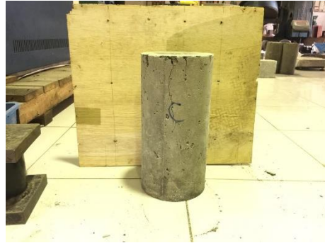
Gambar 39. Tampak sisi C beton setelah uji tekan
