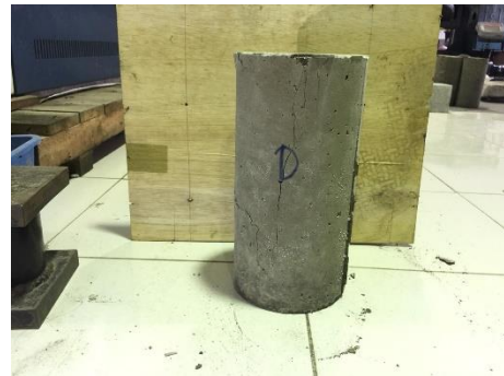
Gambar 35. Tampak sisi D beton setelah uji tekan
