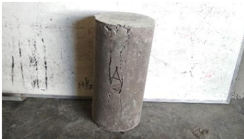
Gambar 102. Tampak sisi A setelah uji tekan
