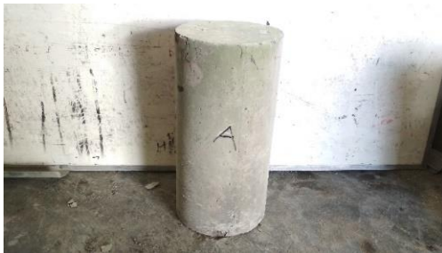
Gambar 117. Tampak sisi A setelah uji tekan
