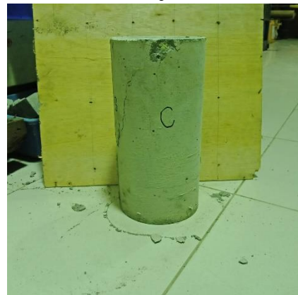
Gambar 44. Tampak sisi C beton setelah uji tekan
