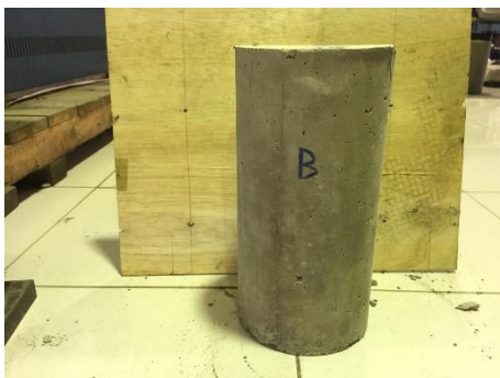
Gambar 38. Tampak sisi B beton setelah uji tekan
