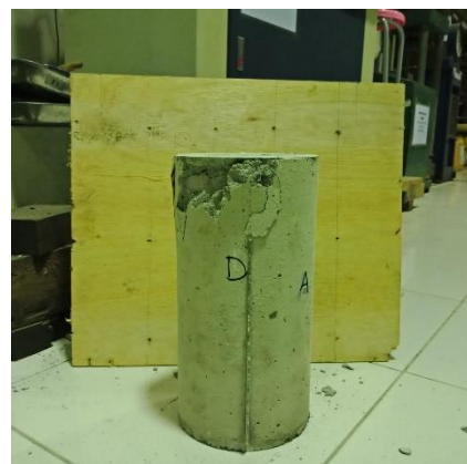
Gambar 45. Tampak sisi D beton setelah uji tekan
