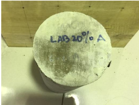
Gambar 31. Tampak sisi atas beton setelah uji tekan
