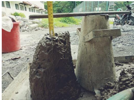
Gambar 125. Tinggi slump 6,5 cm
