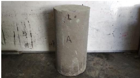
Gambar 52. Tampak sisi A beton setelah uji tekan
