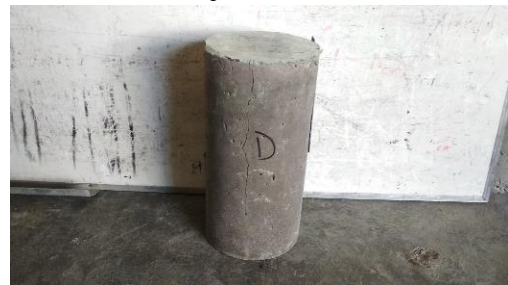
Gambar 105. Tampak sisi D setelah uji tekan
