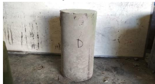
Gambar 100. Tampak sisi D setelah uji tekan
