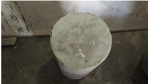
Gambar 91. Tampak atas setelah uji tekan
