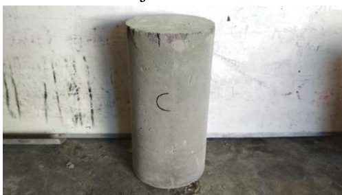
Gambar 119. Tampak sisi C setelah uji tekan
