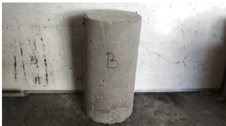
Gambar 53. Tampak sisi B beton setelah uji tekan
