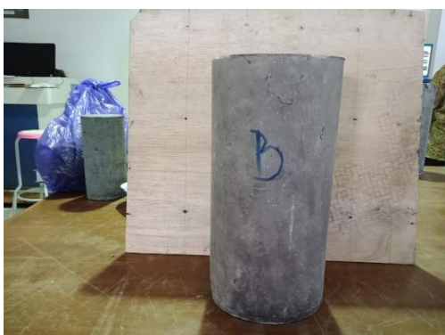
Gambar 23. Tampak sisi B beton setelah uji tekan
