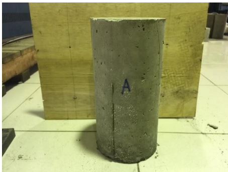
Gambar 32. Tampak sisi A beton setelah uji tekan
