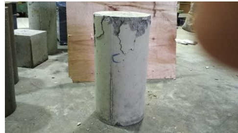
Gambar 4. Tampak sisi C beton setelah uji tekan
