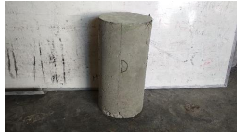
Gambar 115. Tampak sisi D setelah uji tekan
