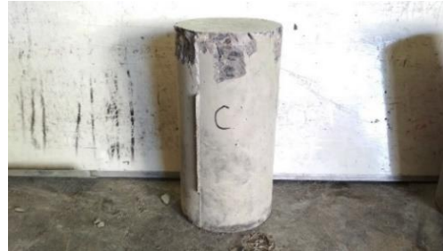
Gambar 84. Tampak sisi C setelah uji tekan
