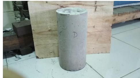
Gambar 30. Tampak sisi D beton setelah uji tekan
