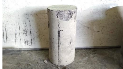
Gambar 89. Tampak sisi C setelah uji tekan
