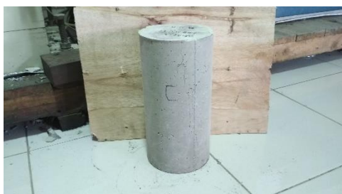
Gambar 29. Tampak sisi C beton setelah uji tekan
