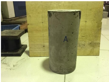
Gambar 37. Tampak sisi A beton setelah uji tekan
