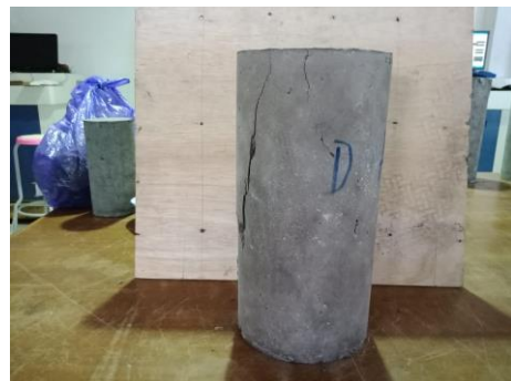
Gambar 10. Tampak sisi D beton setelah uji tekan
