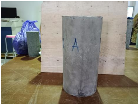
Gambar 7. Tampak sisi A beton setelah uji tekan
