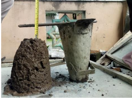
Gambar 127. Tinggi slump 6 cm
