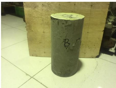
Gambar 63. Tampak sisi B beton setelah uji tekan
