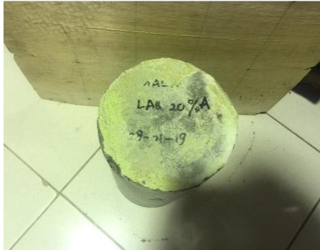
Gambar 71. Tampak sisi atas beton setelah uji tekan
