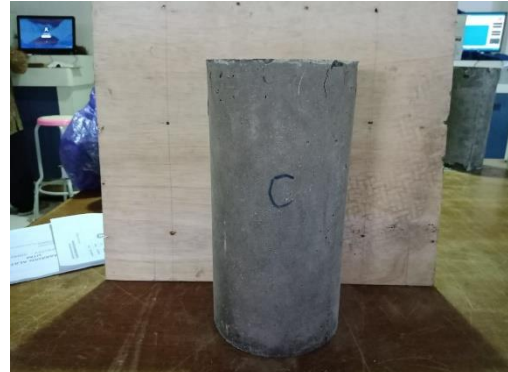
Gambar 24. Tampak sisi C beton setelah uji tekan
