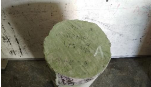
Gambar 81. Tampak atas setelah uji tekan
