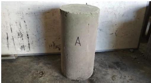
Gambar 97. Tampak sisi A setelah uji tekan
