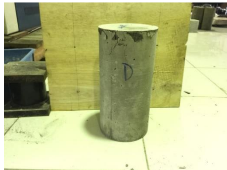
Gambar 15. Tampak sisi D beton setelah uji tekan
