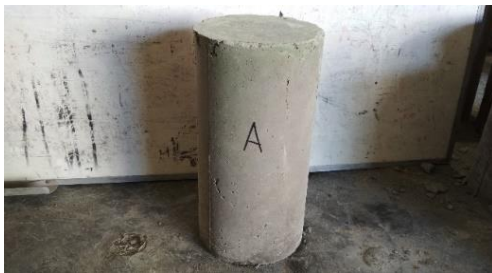
Gambar 57. Tampak sisi A setelah uji tekan
