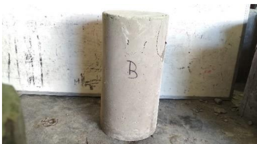
Gambar 98. Tampak sisi B setelah uji tekan
