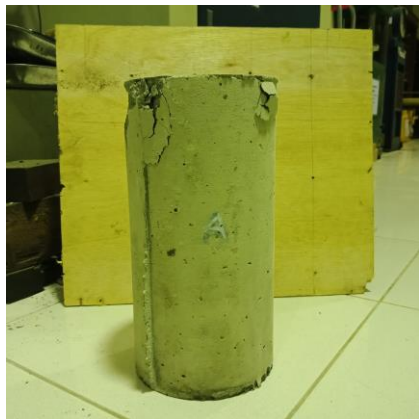
Gambar 47. Tampak sisi A beton setelah uji tekan
