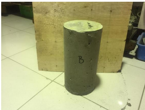
Gambar 78. Tampak sisi B beton setelah uji tekan
