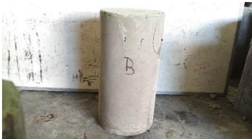
Gambar 58. Tampak sisi B setelah uji tekan
