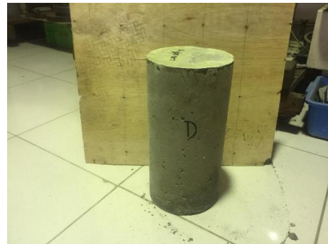
Gambar 65. Tampak sisi D beton setelah uji tekan
