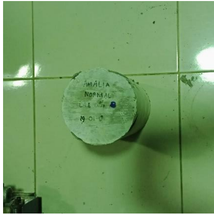
Gambar 46. Tampak sisi atas beton setelah uji tekan
