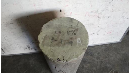
Gambar 101. Tampak atas setelah uji tekan
