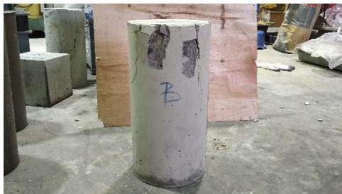
Gambar 3. Tampak sisi B beton setelah uji tekan
