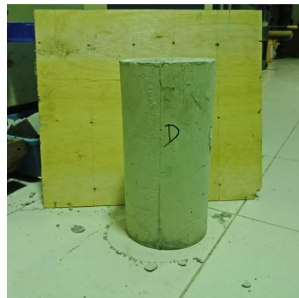
Gambar 50. Tampak sisi D beton setelah uji tekan
