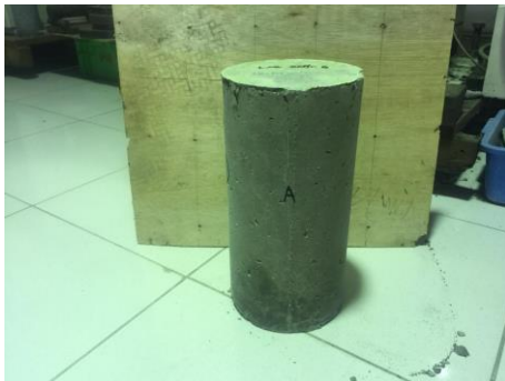
Gambar 72. Tampak sisi A beton setelah uji tekan
