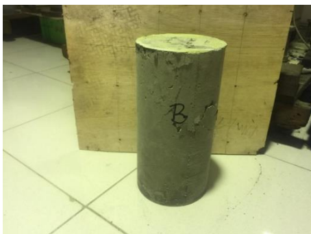
Gambar 73. Tampak sisi B beton setelah uji tekan
