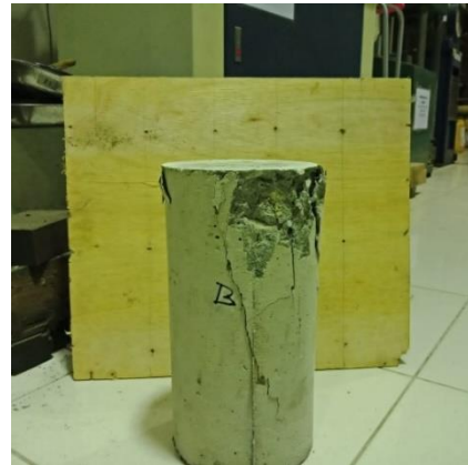
Gambar 43. Tampak sisi B beton setelah uji tekan
