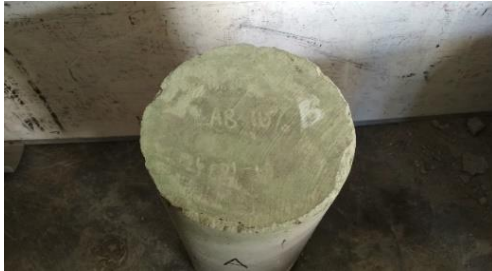
Gambar 56. Tampak atas setelah uji tekan
