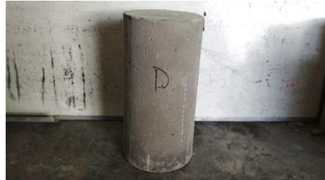
Gambar 55. Tampak sisi D beton setelah uji tekan
