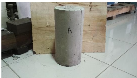
Gambar 27. Tampak sisi A beton setelah uji tekan
