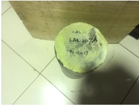
Gambar 61. Tampak sisi atas beton setelah uji tekan
