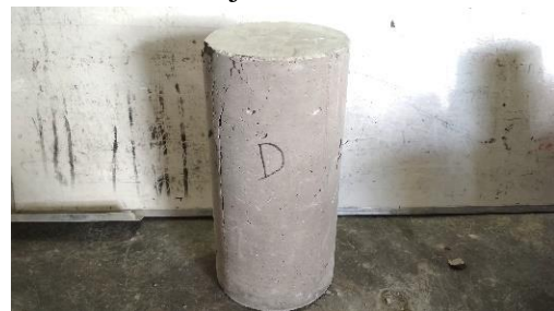
Gambar 95. Tampak sisi D setelah uji tekan
