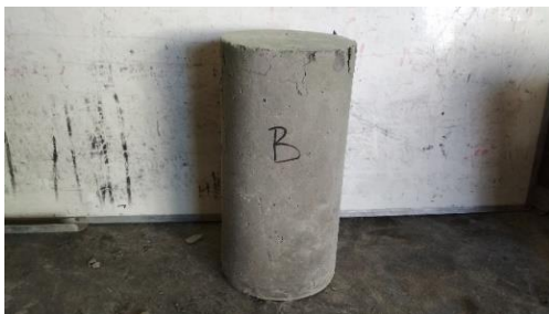
Gambar 118. Tampak sisi B setelah uji tekan
