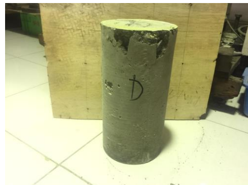
Gambar 70. Tampak sisi D beton setelah uji tekan
