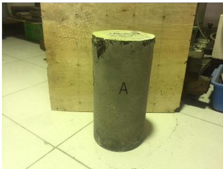
Gambar 62. Tampak sisi A beton setelah uji tekan
