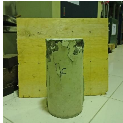
Gambar 49. Tampak sisi C beton setelah uji tekan
