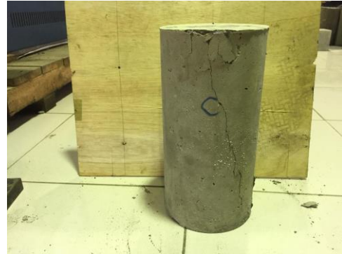
Gambar 19. Tampak sisi C beton setelah uji tekan
