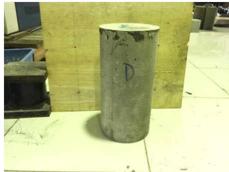
Gambar 40. Tampak sisi D beton setelah uji tekan
