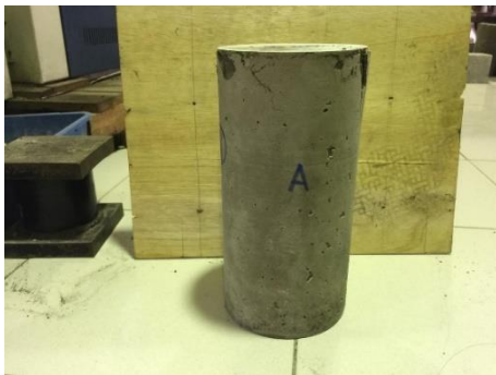
Gambar 12. Tampak sisi A beton setelah uji tekan
