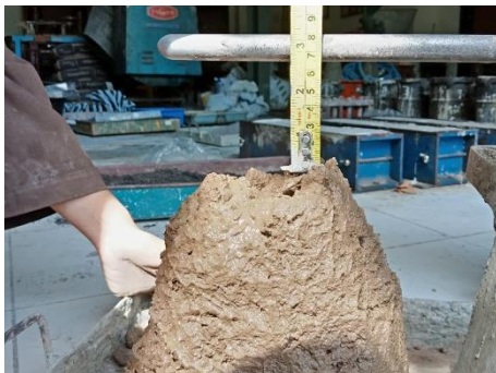
Gambar 123. Tinggi slump 6,5 cm
