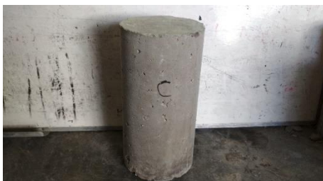
Gambar 54. Tampak sisi C beton setelah uji tekan
