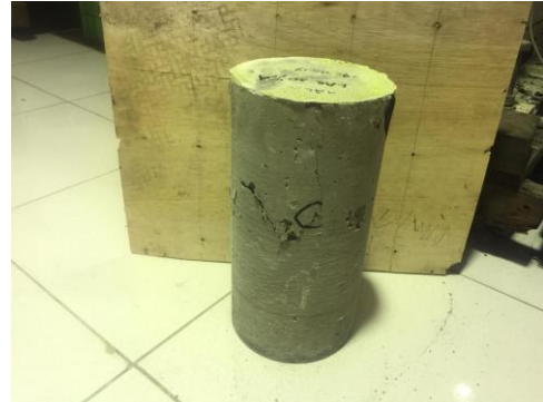
Gambar 69. Tampak sisi C beton setelah uji tekan
