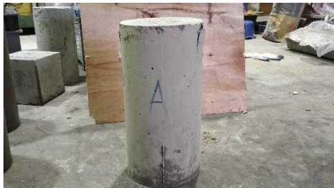
Gambar 2. Tampak sisi A beton setelah uji tekan
