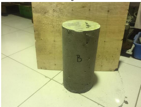
Gambar 68. Tampak sisi B beton setelah uji tekan
