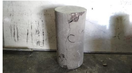
Gambar 94. Tampak sisi C setelah uji tekan
