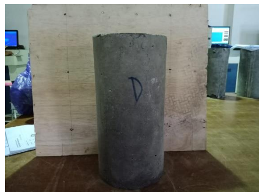
Gambar 25. Tampak sisi D beton setelah uji tekan
