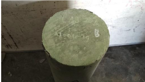
Gambar 116. Tampak atas setelah uji tekan
