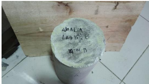
Gambar 26. Tampak sisi atas beton setelah uji tekan
