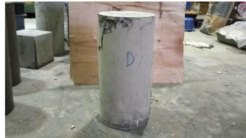
Gambar 5. Tampak sisi D beton setelah uji tekan
