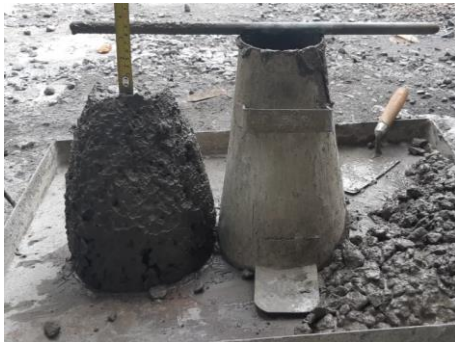
Gambar 122. Tinggi slump 8 cm
