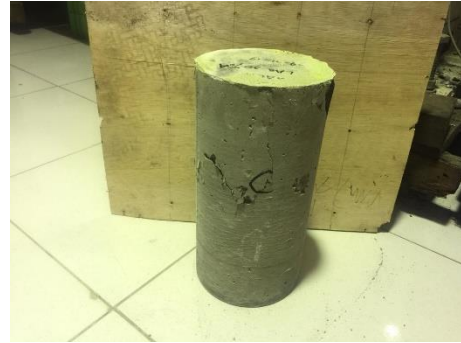
Gambar 64. Tampak sisi C beton setelah uji tekan
