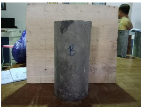
Gambar 8. Tampak sisi B beton setelah uji tekan
