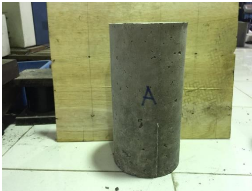
Gambar 17. Tampak sisi A beton setelah uji tekan
