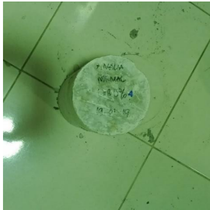
Gambar 41. Tampak sisi atas beton setelah uji tekan
