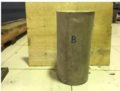
Gambar 13. Tampak sisi B beton setelah uji tekan
