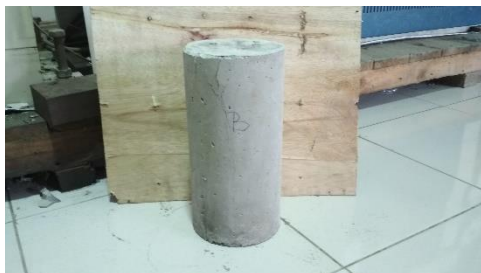
Gambar 28. Tampak sisi B beton setelah uji tekan
