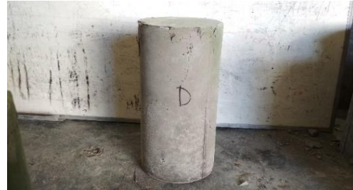
Gambar 60. Tampak sisi D setelah uji tekan
