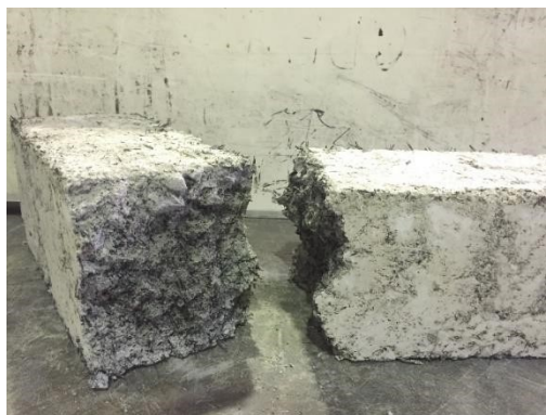
Gambar 26. Beton f_c' 35 MPa dengan tambahan serbuk ban bekas setelah dilakukan uji lentur
