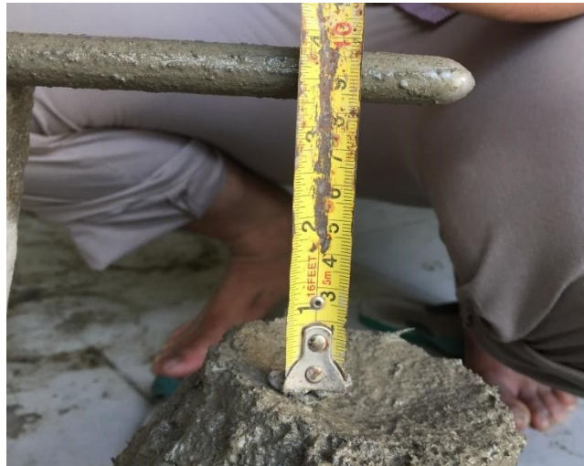
Gambar 18. Nilai slump pada beton f_c' 35 MPa
