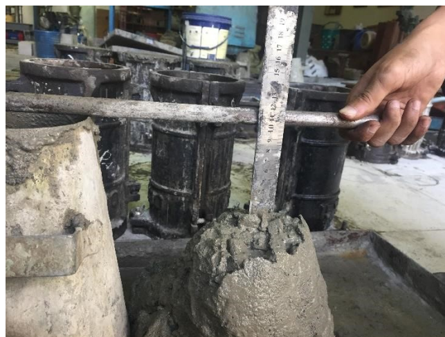
Gambar 19. Nilai slump pada beton f_c' 17 MPa
