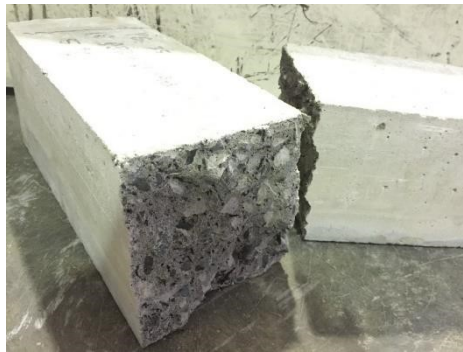
Gambar 25. Beton normal f_c' 35 MPa setelah dilakukan uji lentur
