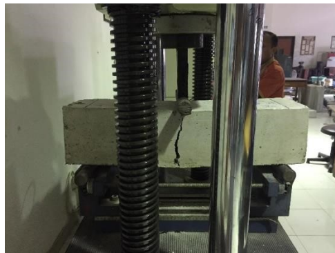
Gambar 24. Pengujian kuat lentur beton
