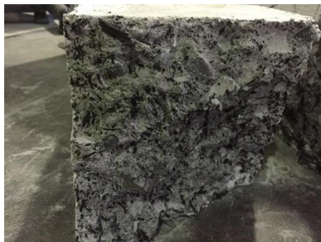
Gambar 26. Beton f_c' 35 MPa dengan tambahan serbuk ban bekas setelah dilakukan uji lentur
