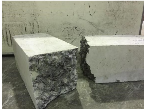
Gambar 25. Beton normal f_c' 17 MPa setelah dilakukan uji lentur
