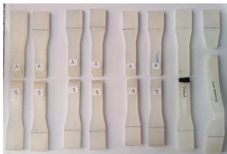
**Gambar 4.15** Patahan spesimen setelah pengujian tarik
