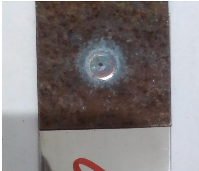
Gambar 2. 3 Permukaan nugget hasil lasan spot TIG welding pada sisi bagian material baja karbon rendah.
