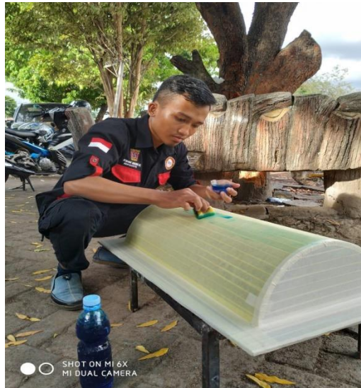
Gambar 3.16 Proses pengolesan cairan pva
