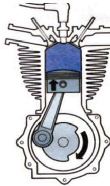
Gambar 2.3. Prinsip kerja langkah Kompresi (Suyanto, 2000)
