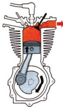
Gambar 2.5. Prinsip kerja langkah Buang (Suyanto, 2000)
