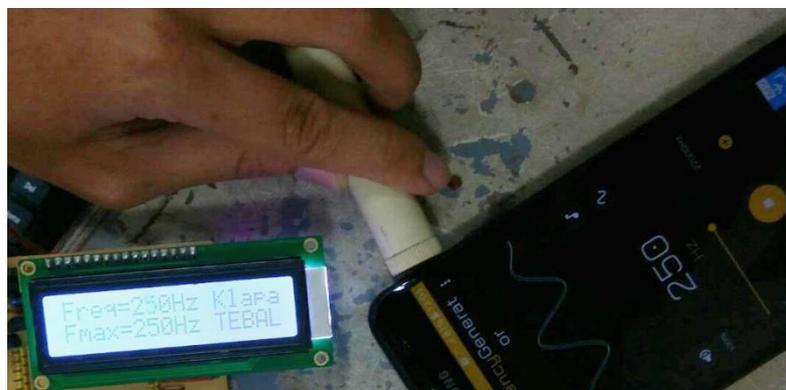
Gambar 4.1. (b) Pengujian Rangkaian Frekuensi 250Hz
