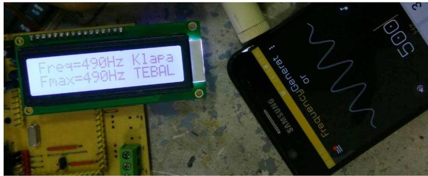
Gambar 4.1. (f) Pengujian Rangkaian Frekuensi 500Hz
