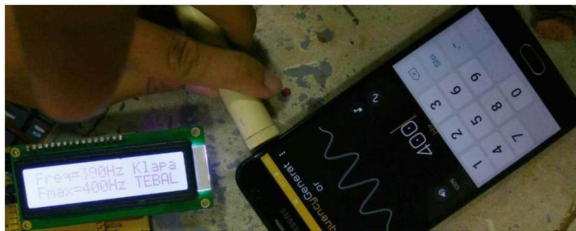
Gambar 4.1. (d) Pengujian Rangkaian Frekuensi 400Hz
