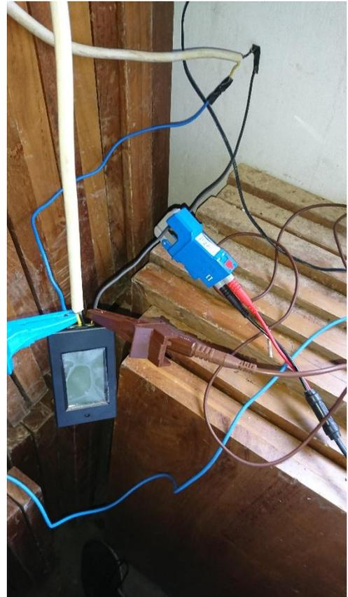
Gambar 3. 10 Pemasngan pada kabel Fasa-Netral Pada SHS
