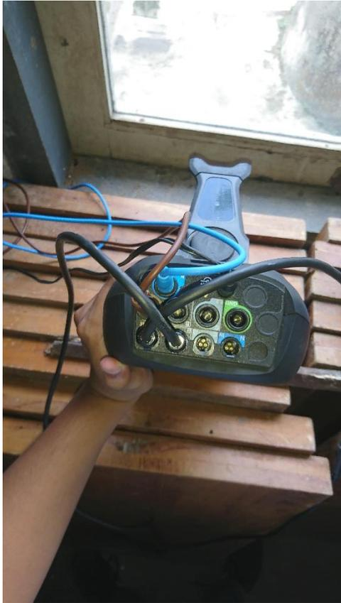
Gambar 3. 9 Pemasngan Kabel *Probe* pada alat Metrel
