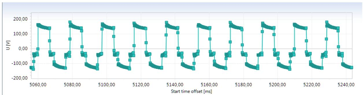
Gambar 4. 59 Sinus Netral pada pengukuran *Inverter*
