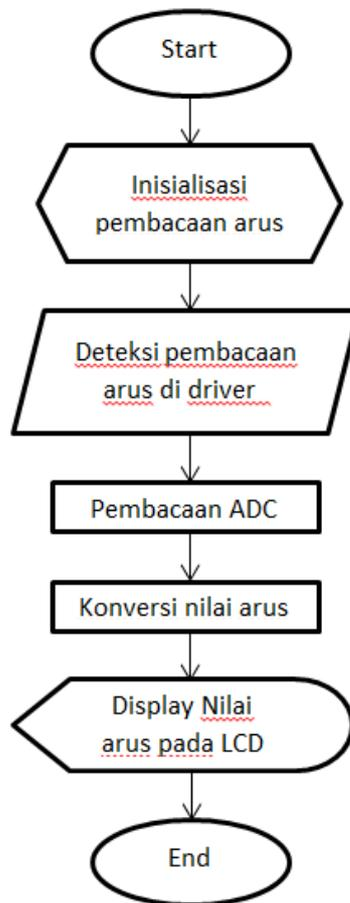
Gambar 2.2 Diagram Alir Proses pembacaan arus
