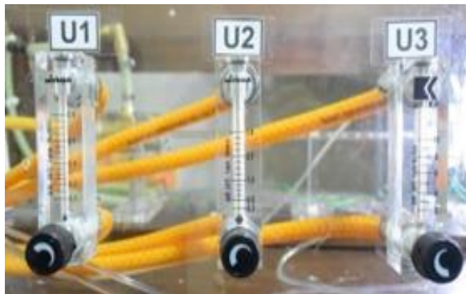
Gambar 3.6 Flowmeter udara dengan kisaran debit maksimal 0 - 0,8 L/m, 0 - 3 L/m dan 0 - 10 L/m.
