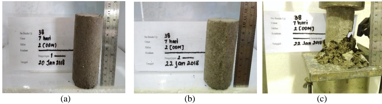
Gambar 22 (a) Setelah 1 siklus (b) Setelah 2 siklus (c) Setelah pengujian
