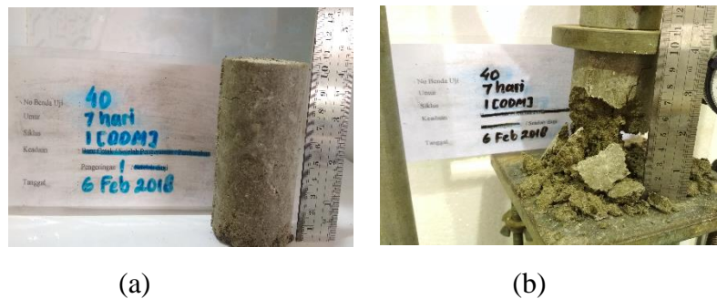
Gambar 21 (a) Setelah 1 siklus (b) Setelah pengujian
