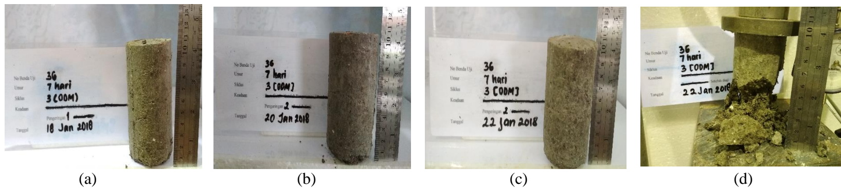
Gambar 23 (a) Setelah 1 siklus (b) setelah 2 siklus (c) Setelah 3 siklus (d) Setelah pengujian
