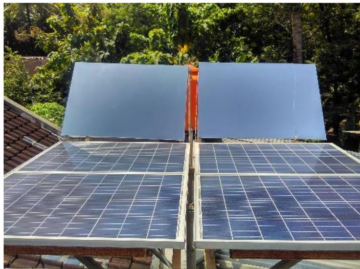
Gambar 4.4 Panel surya dengan Reflektor Cermin Datar
