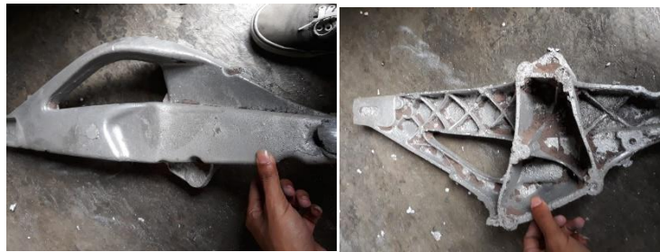
Gambar 3.13. Hasil Cetakan Swingarm
