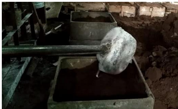
Gambar 3.11. Penuangan Hasil Peleburan Ke Dalam Cetakan
