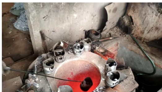
Gambar 3.10. Peleburan Piston Diesel
