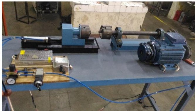
Gambar 4. 1 alat las gesek ( friction welding )
