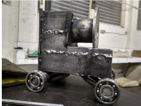
Gambar 4. 8 cekam yang akan didorong pneumatik
