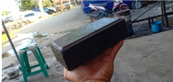
Gambar 4.7 Paving Block Balok Sebelum Pengujian
