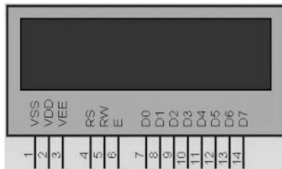
Gambar 2.6 Konfigurasi Pin Kaki LCD
