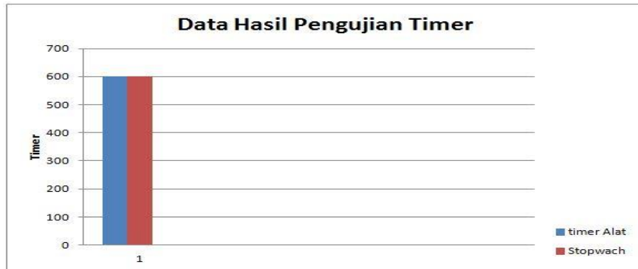
Gambar 4.1 Grafik Hasil Pengukuran Modul alat dengan alat pembanding Stopwatch pada penghitungan 600 detik.
