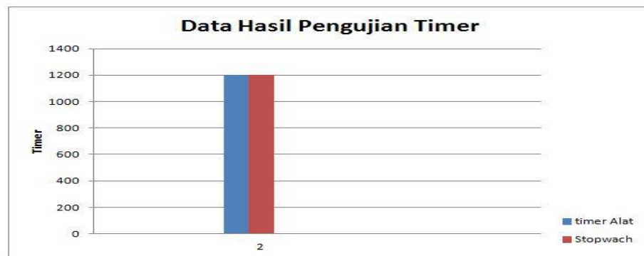
Gambar 4.2 Grafik Hasil Pengukuran Modul alat dengan alat pembanding Stopwatch pada penghitungan 1200 detik.
