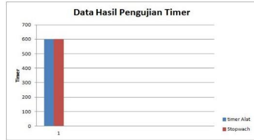
Gambar 4.1 Grafik Hasil Pengukuran Modul alat dengan alat pembanding Stopwatch pada penghitungan 600 detik.
