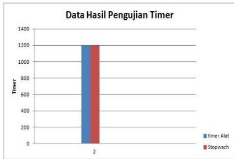
Gambar 4.2 Grafik Hasil Pengukuran Modul alat dengan alat pembanding Stopwach pada penghitungan 1200 detik.
