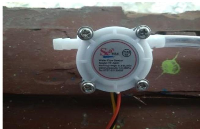
Gambar 3.8 Pemasangan sensor YF-S401
