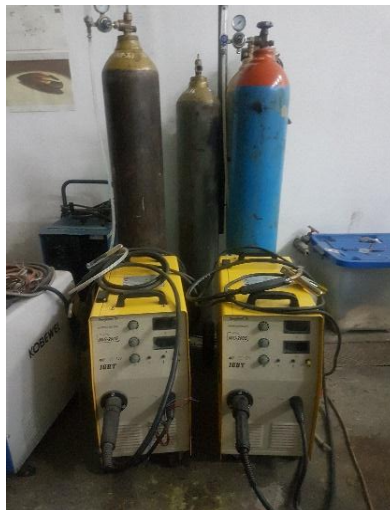
Gambar 3.3. Mesin Las Tenjima MIG-200s
