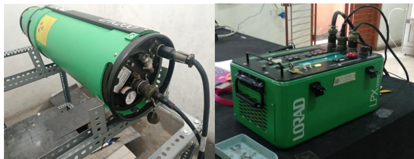
Gambar 3.6. Alat Radiografi Test LORAD LPX 200
