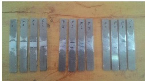
Gambar 2.4. Spesimen uji bending
