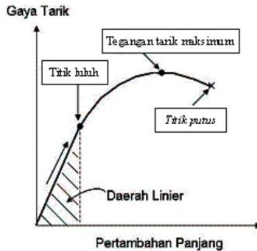
Gambar 2.3 Kurva hasil pengujian tarik berupa kurva gaya-perpanjangan
