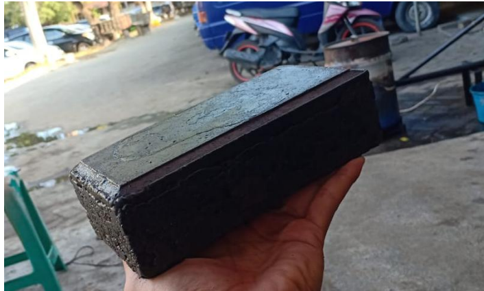
Gambar 4.2 Paving Blok Hasil Dari Lelehan Botol Plastik
