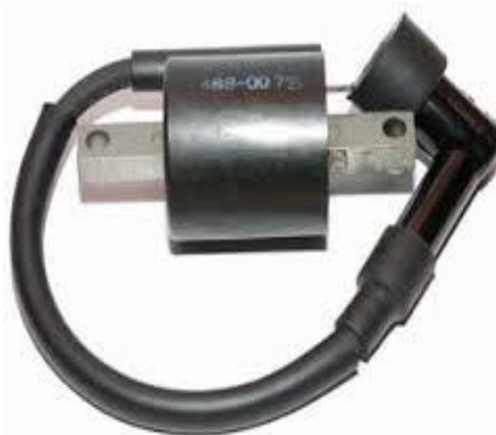
Gambar 2. 7 Bentuk fisik koil motor [9].
