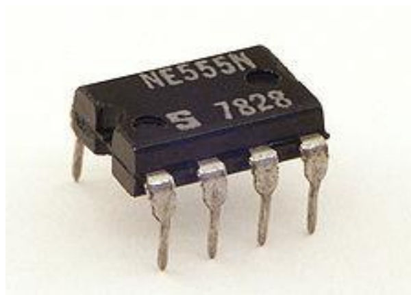
Gambar 2. 3 Bentuk fisik IC NE555
