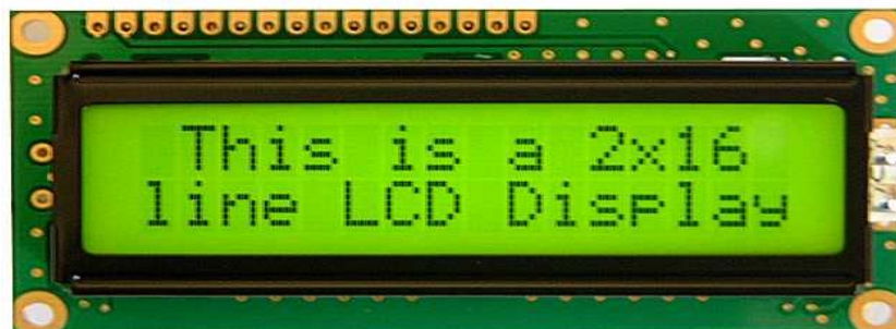
Gambar 2. 4 Bentuk Fisik LCD 16 x 2[8].
