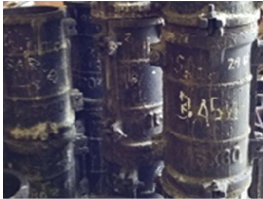
Gambar 3.7. Cetakan silinder beton
