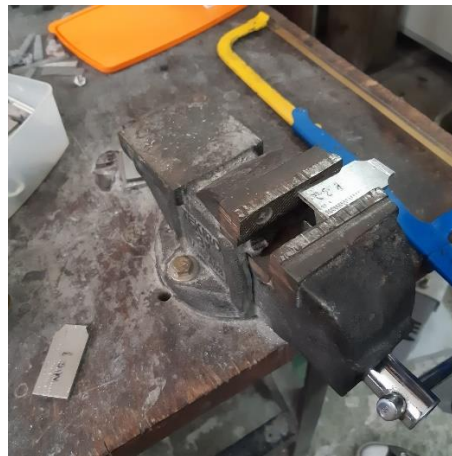
Gambar 3.11 Pemotongan spesimen untuk pengamatan mikro
