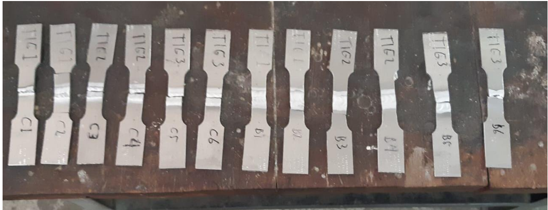
Gambar 3.10 Spesimen hasil pengujian tarik
