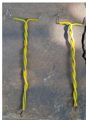
Gambar 3.8 Pemasangan penggantung/ jig
