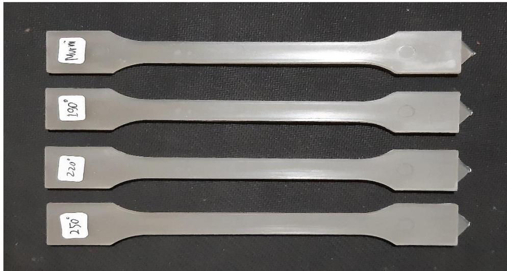
**Gambar 4.2.** Spesimen *multipurpose polypropylene* daur ulang
