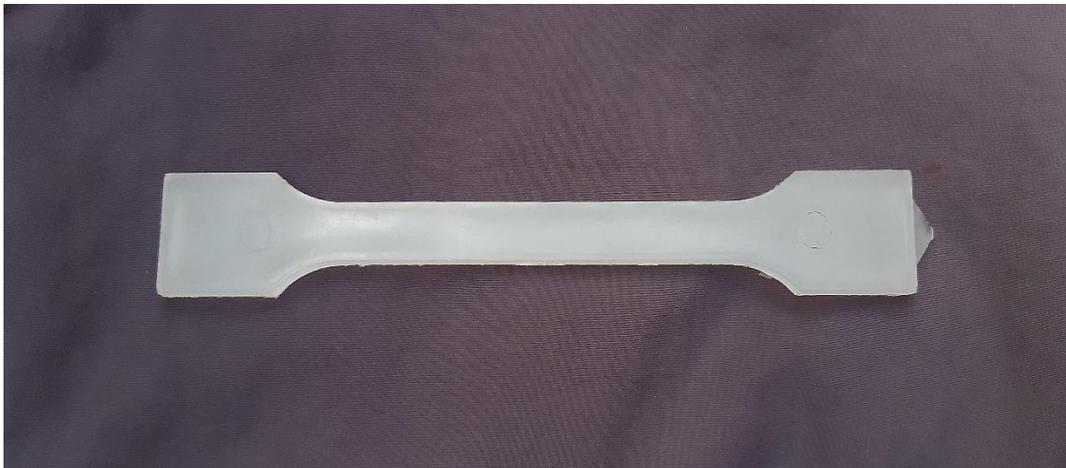
**Gambar 4.1.** Spesimen *Multipurpose* PP daur ulang
