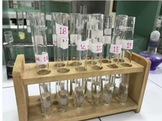
Gambar 10. Perendaman sampel pada saliva buatan didalam tabung reaksi.
