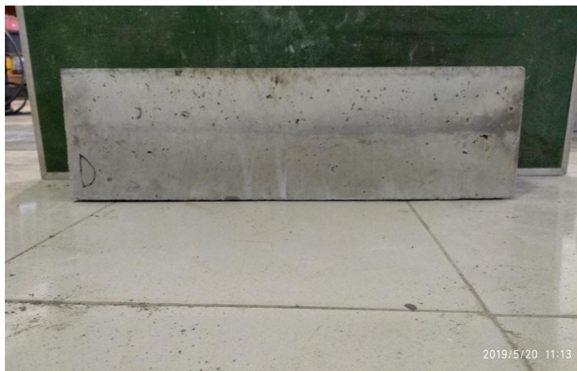
Gambar 5. Hasil pembuatan beton cold joint
