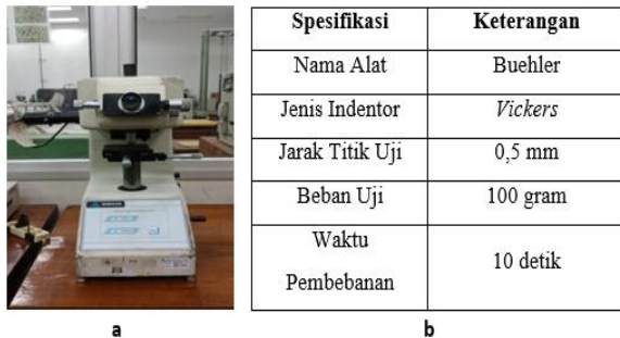
Gambar 7. (a) Mesin uji kekerasan. (b) Spesifikasi mesin uji
