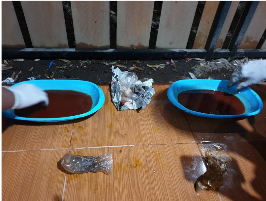
Gambar 3. 14 Proses Etching PCB Digoyangkan dalam Larutan Ferric Chloride
