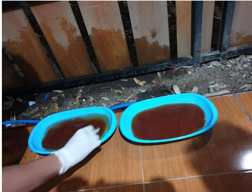
Gambar 3. 13 Proses Etching PCB Didiamkan dalam Larutan Ferric Chloride
