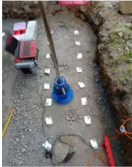
Gambar 3.18 Titik- titik Pengujian LWD ( Light Weight Deflectometer )
