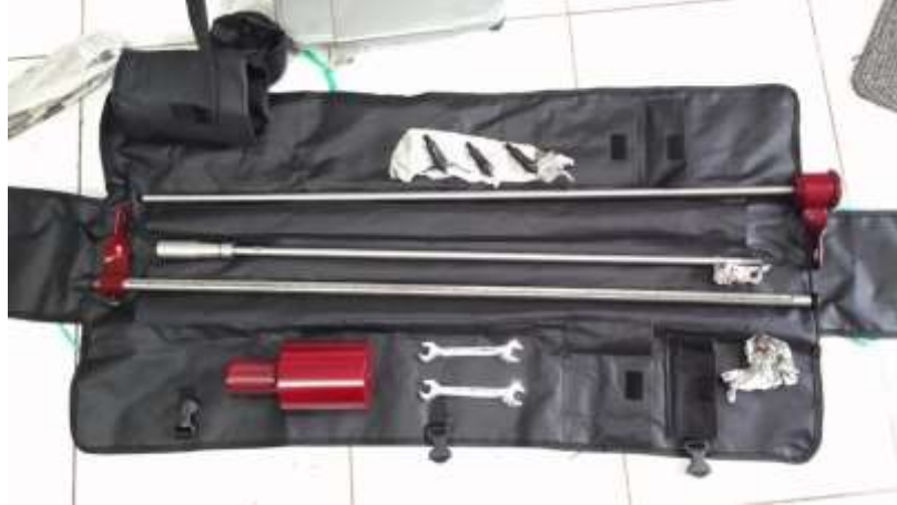
Gambar 3.14 Bagian - bagian alat DCP
