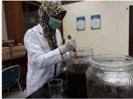
Proses ekstraksi menggunakan metode Maserasi
