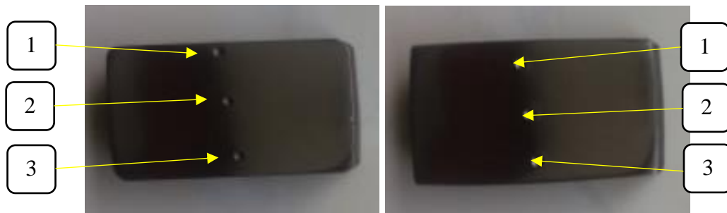
Gambar 4.13 Spesimen uji kekerasan.
