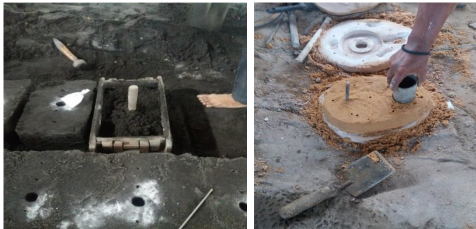
Gambar 4.3 Pembuatan lubang penuangan cairan pada cetakan.
