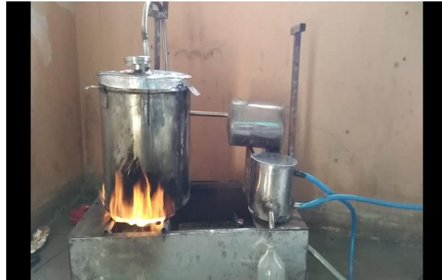
Gambar 4.4 Proses Pirolisis Pengambilan Minyak
