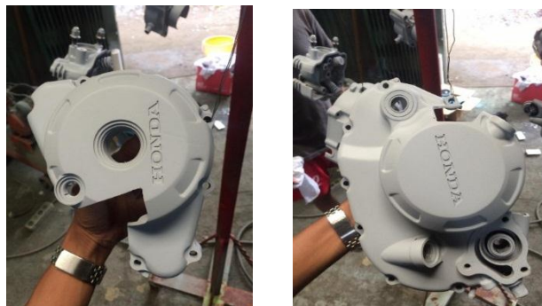
Gambar 3.6 Hasil setelah di epoxy
