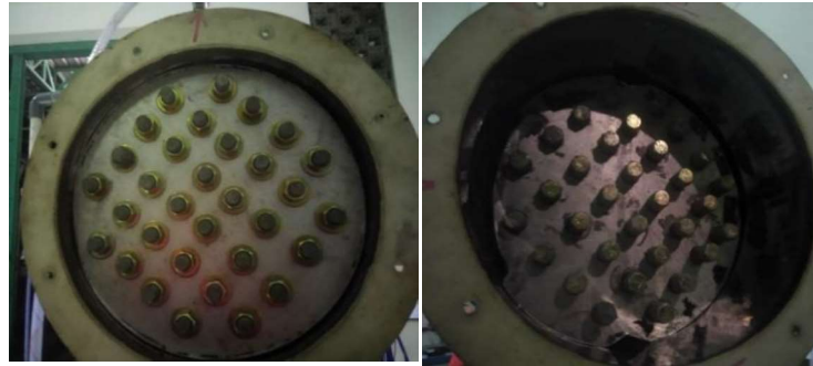
Gambar 3. 9. Dudukan penopang pipa tembaga.
