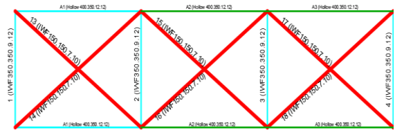
Gambar 25 Batang/frame 13-18 (IWF150.150.7.10) yang mengalami overstressed
