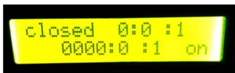
Gambar 5 Kondisi tampilan LCD saat *hourmeter* mulai menghitung.
