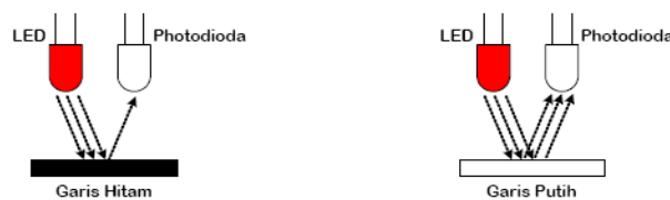
Gambar 2.13 Ilustrasi Mekanisme Kerja Sensor LED-Photodioda
