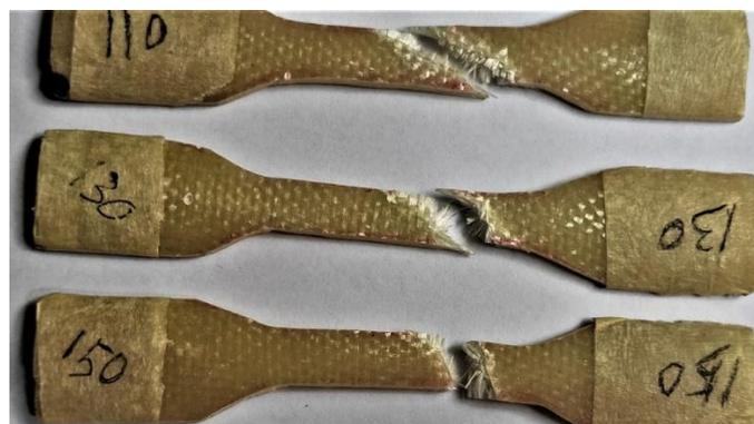
Gambar 3.7 Spesimen hasil pengujian tarik variasi temperatur *curing*.
