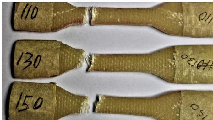
Gambar 3.8 Spesimen hasil pengujian tarik variasi temperatur *post-curing*.
