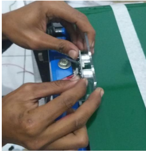
Gambar 4.26 Pemasangan sensor ultrasonik
