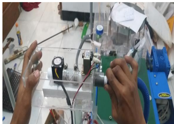
Gambar 4.25 Pemasangan selang pada katup solenoid
