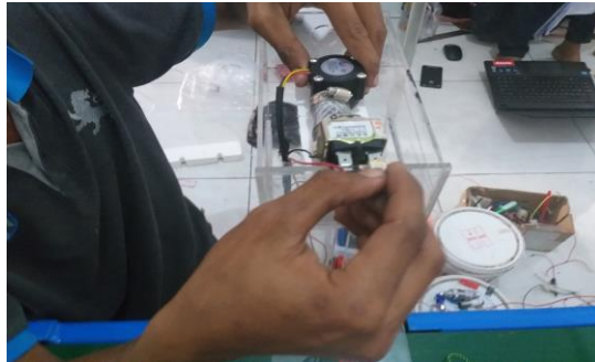
Gambar 4.24 Pemasangan katup solenoid dan flow meter
