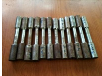
Gambar 9 Contoh spesimen pengujian kekuatan tarik kondisi I dan kondisi II
