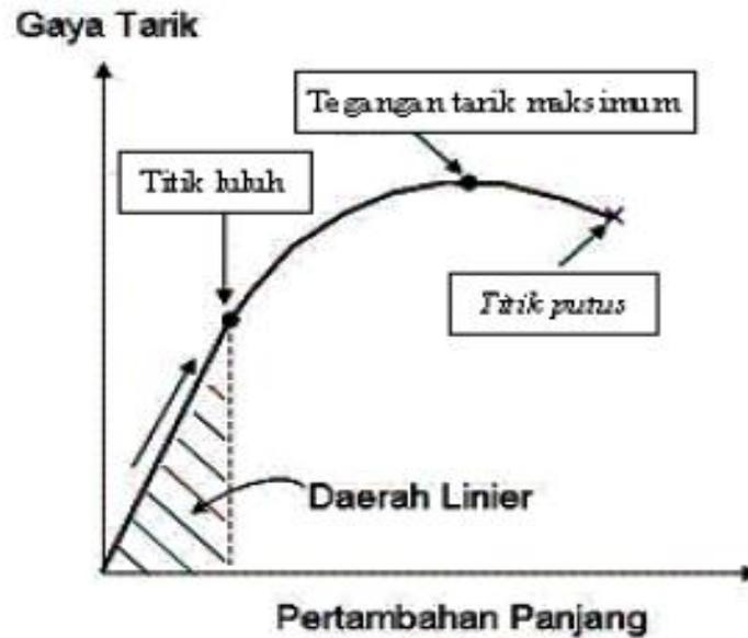
Gambar 2.4 Kurva tegangan - regangan (Salihendo dkk 2013)
