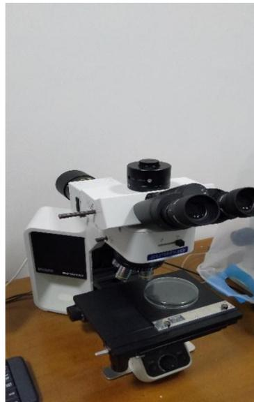
Gambar 3.4 Alat uji struktur mikro
