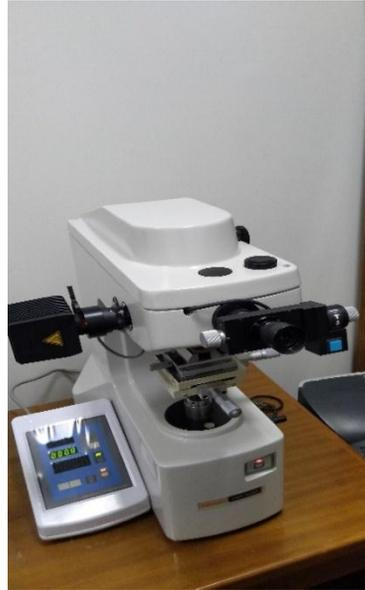
Gambar 3.3 Alat uji kekerasan *Vickers*
